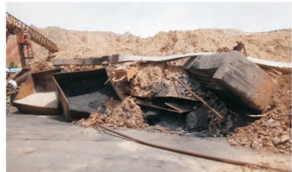
图 9 第 II-1 轮滑动后被推动的混凝土柱
