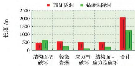
图5 围岩破坏坑深 $\leq 0.5$  m的分布长度
