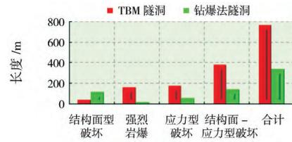
图7 围岩破坏坑深1~3 m的分布长度
