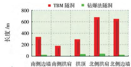
图3 应力型破坏在不同部位的破坏长度
