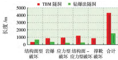
图1 各隧洞围岩破坏长度对比(单位:m)
