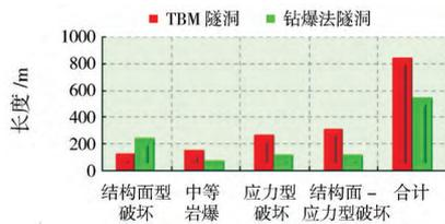
图6 围岩破坏坑深0.5~1 m的分布长度
