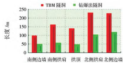
图2 岩爆在不同部位的破坏长度
